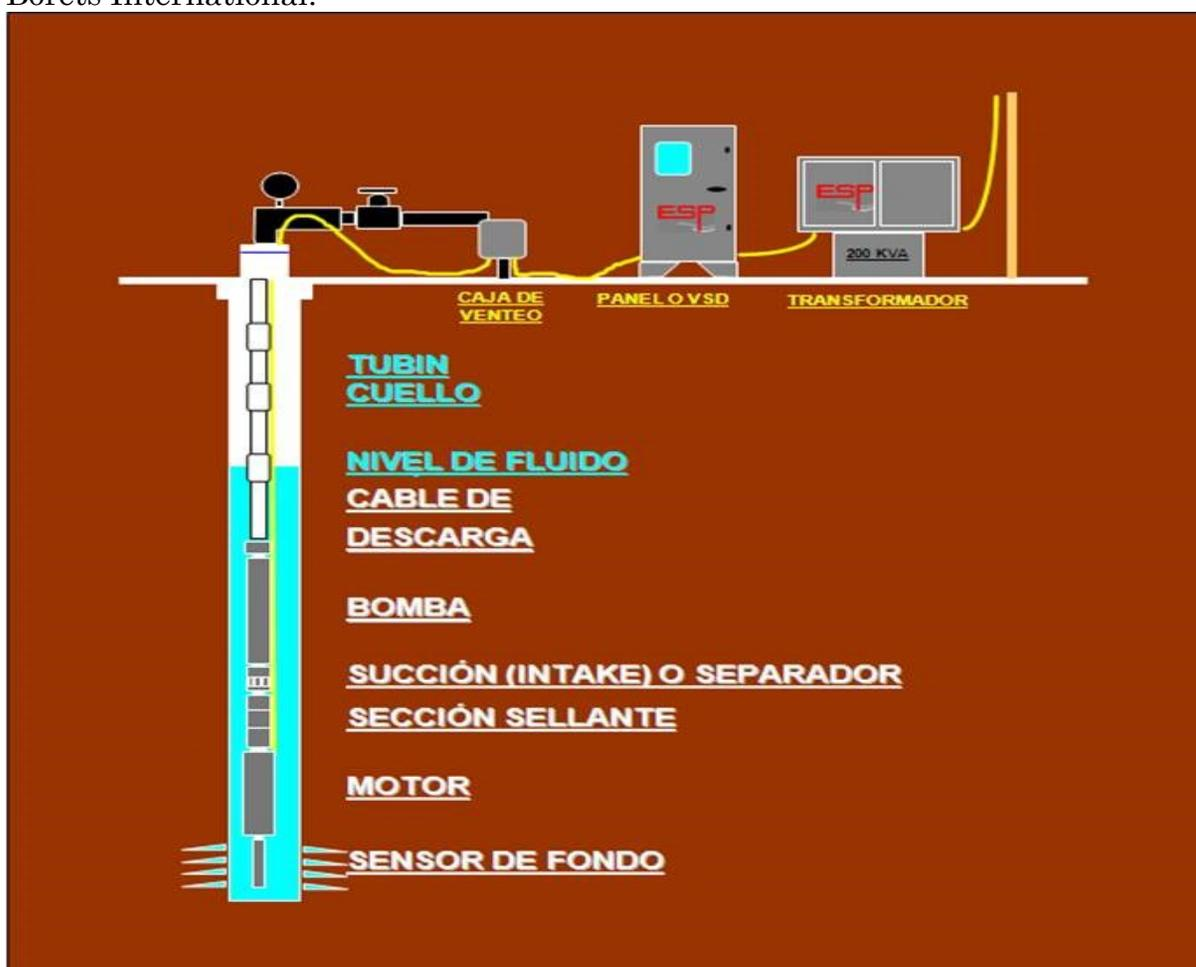
Foto de ilustración del sistema de bombeo electrosumergible (BES)
