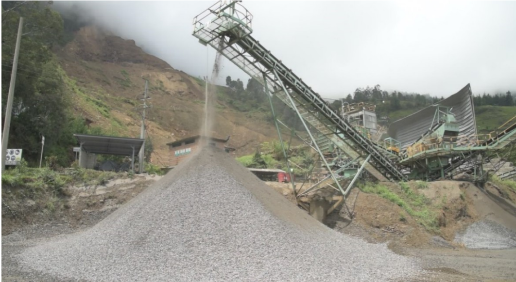
Imagen de una de las dos plantas de trituración. Una emplea una trituradora de cono y la otra una trituradora de martillo
