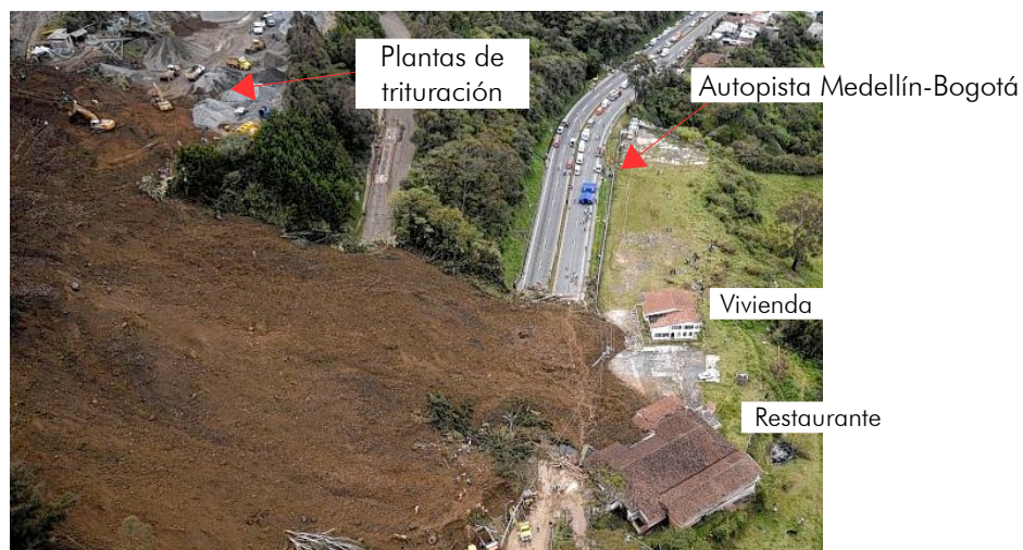
Imagen aérea de la zona afectada por el deslizamiento. Se observa la ubicación de las plantas de trituración y de las dos edificaciones ubicadas al frente de la planta asegurada, hasta donde llegó el material deslizado
