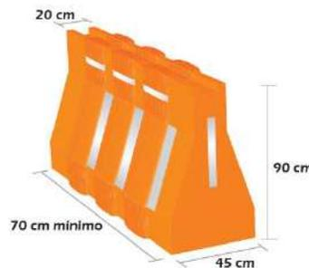
Estos dispositivos se pueden utilizar como elementos de canalización de tránsito en los casos en que sea necesario definir una variación en el perfil transversal disponible para el tránsito de vehículos o para indicar el alineamiento en tramos rectos y curvas o para aislar excavaciones hasta de 1,0 metro de profundidad.
