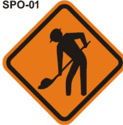
Esta señal se empleará para advertir la proximidad a un tramo de la vía que se ve afectado por la ejecución de una obra que perturba el tránsito por la calzada o sus zonas aledañas.
