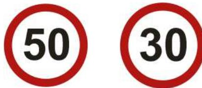
Esta señal se utiliza para indicar la velocidad máxima a la que pueden circular los vehículos a partir del lugar donde esté instalada. Se utilizará inicialmente con velocidad 50 Km/h para llegar a una velocidad máxima de tránsito en la zona de obra y de aproximación de 30 Km/h.
