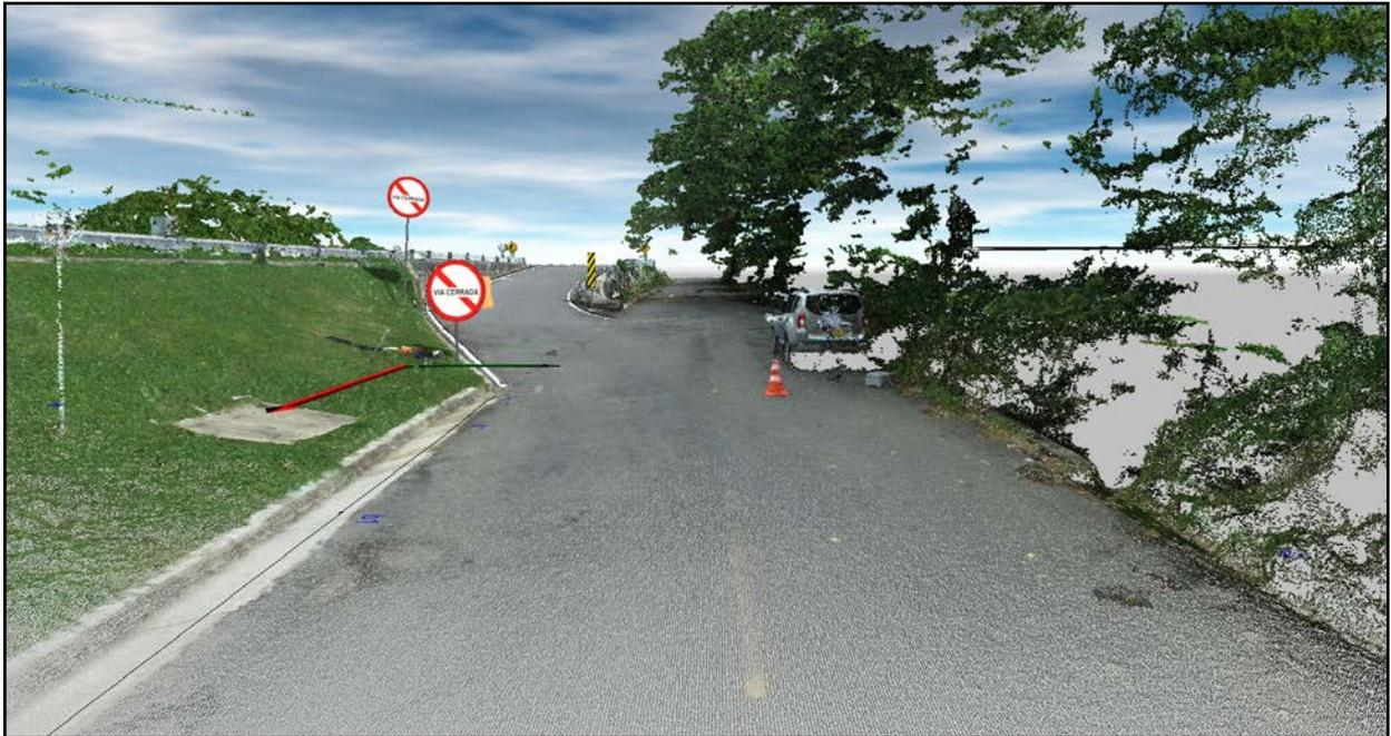
Figura 43. Reconstrucción 3D del lugar de los hechos, mediante la fijación topográfica de la vía con estación total, complementando la topografía con la fotogrametría mediante nube de puntos. Se reconstruye la ubicación de las señales verticales de acuerdo con lo observado en las imágenes documentadas el día de los hechos y un día posterior.
