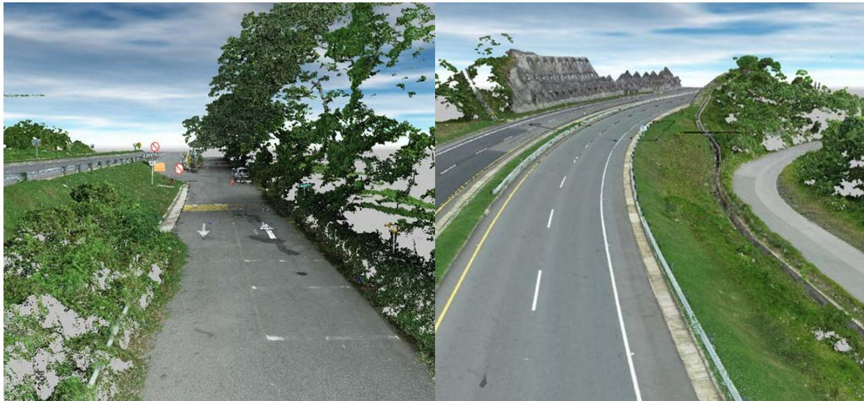
Figura 4. Reconstrucción 3D realizada mediante el procesamiento de imágenes usando software Metashape Agisoft y WebODM, elementos que complementan las medidas registradas con la estación total. Reconstrucción del lugar de los hechos realizada en software Faro Zone 3D. Imagen izquierda km 23 + 700 metros. Imagen derecha km 22 + 400 metros.
