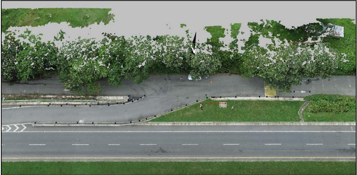
Figura 41. Plano cenital reconstrucción del lugar de los hechos km 23 + 700 metros, mediante la fijación topográfica de la vía con estación total, complementando la topografía con la fotogrametría mediante nube de puntos realizada con software WebODM y Agisoft, importados en software de reconstrucción Faro Zone 3D.
