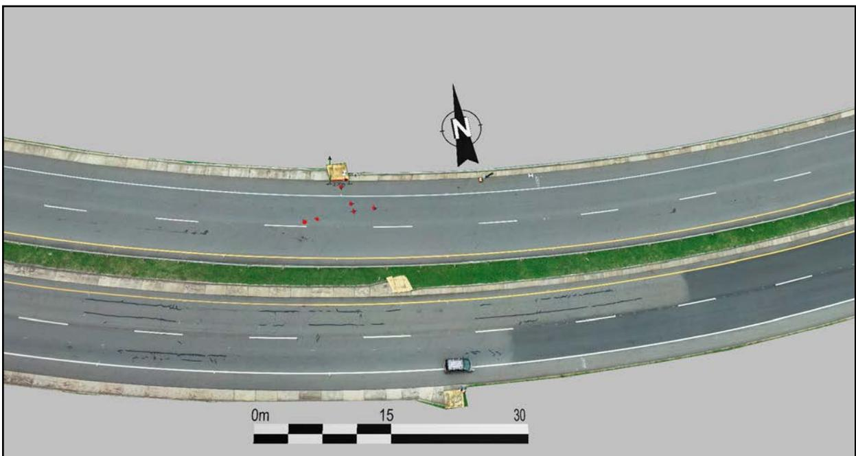
Figura 48. Plano cenital reconstrucción del lugar de los hechos km 22 + 400 metros, mediante la fijación topográfica de la vía con estación total, complementando la topografía con la fotogrametría mediante ortomosaico, reconstrucción realizada con software Faro Zone 3D. Los puntos rojos ilustran la reconstrucción de las medidas registradas en el bosquejo topográfico elaborado por la policía judicial.
