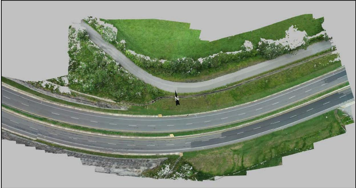
Figura 47. Plano cenital reconstrucción del lugar de los hechos km 22 + 400 metros, mediante la fijación topográfica de la vía con estación total, complementando la topografía con la fotogrametría mediante ortomosaico realizada con software WebODM.
