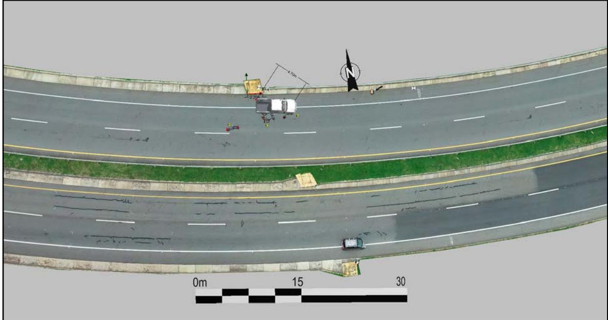
Figura 49. Plano cenital reconstrucción del lugar de los hechos km 22 + 400 metros. Se reconstruye la posición final de los dos vehículos y del occiso, con base en las medidas del bosquejo topográfico elaborado por la policía judicial, sobre la fotogrametría y topografía elaborada por el suscrito perito.
