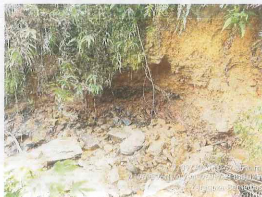
Proceso de socavación y remoción en masa identificado sobre el cauce aproximadamente a 20 metros aguas abajo del proyecto
