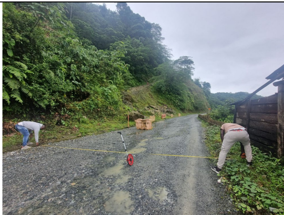
Medición ancho-calzada tramo inicial
