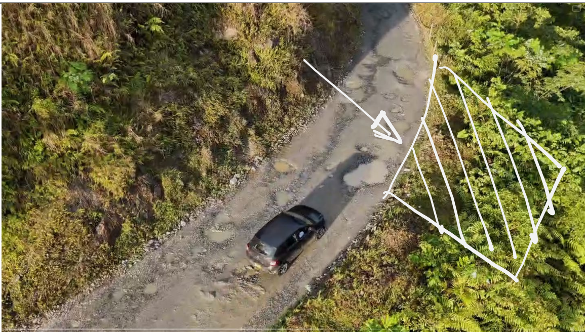
Se evidencia en esta imagen zona donde ocurrió el accidente que de acuerdo a la documentación se presenta cuando el vehículo de placas Placas TNH 442 se precipito al dar marcha atrás en una zona crítica de baja visibilidad encontrándose con otro vehículo, se evidencia que no hay intervención alguna actualmente ni con barreras de seguridad ni otros elementos de contención.
